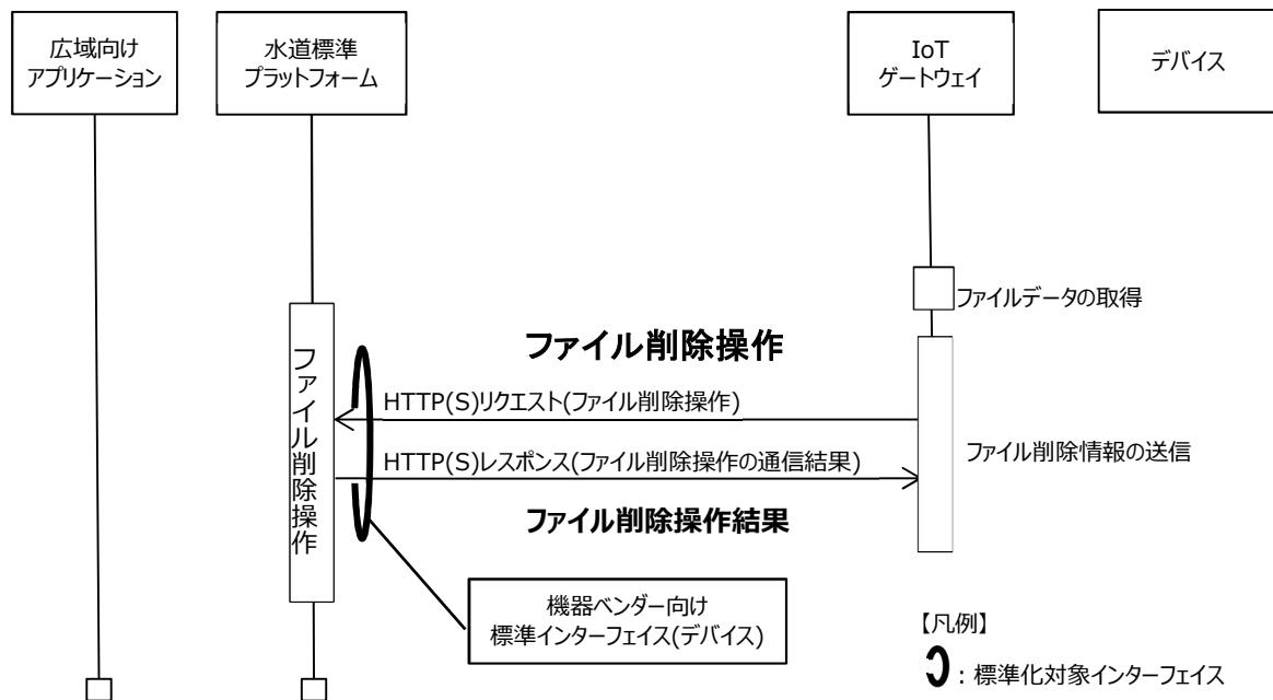
図 4-7: ファイル削除操作の詳細フロー
