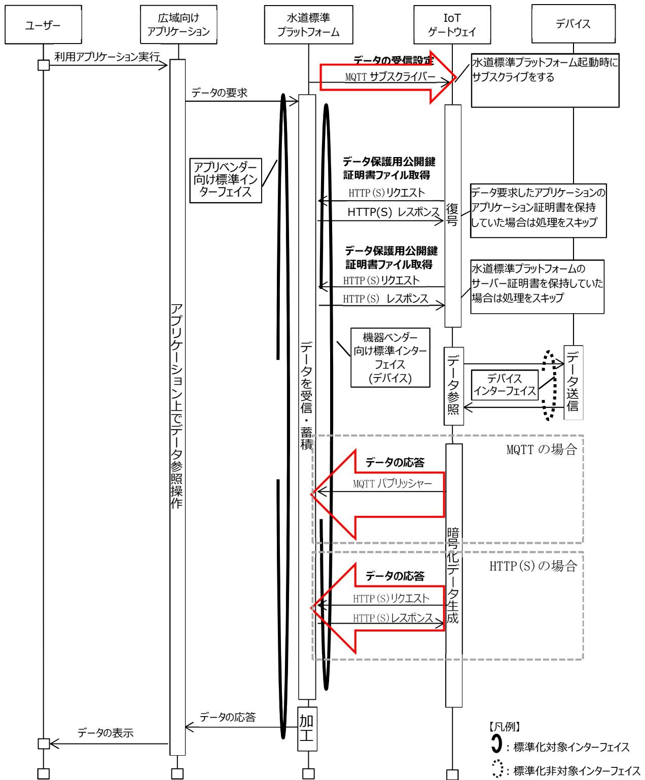
図 3-11: 詳細フロー(データ操作(参照)プル型)
