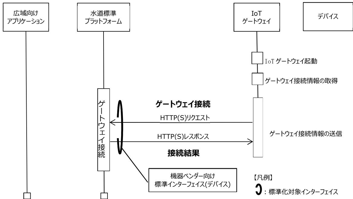
図 3-9: 詳細フロー(ゲートウェイ接続)
