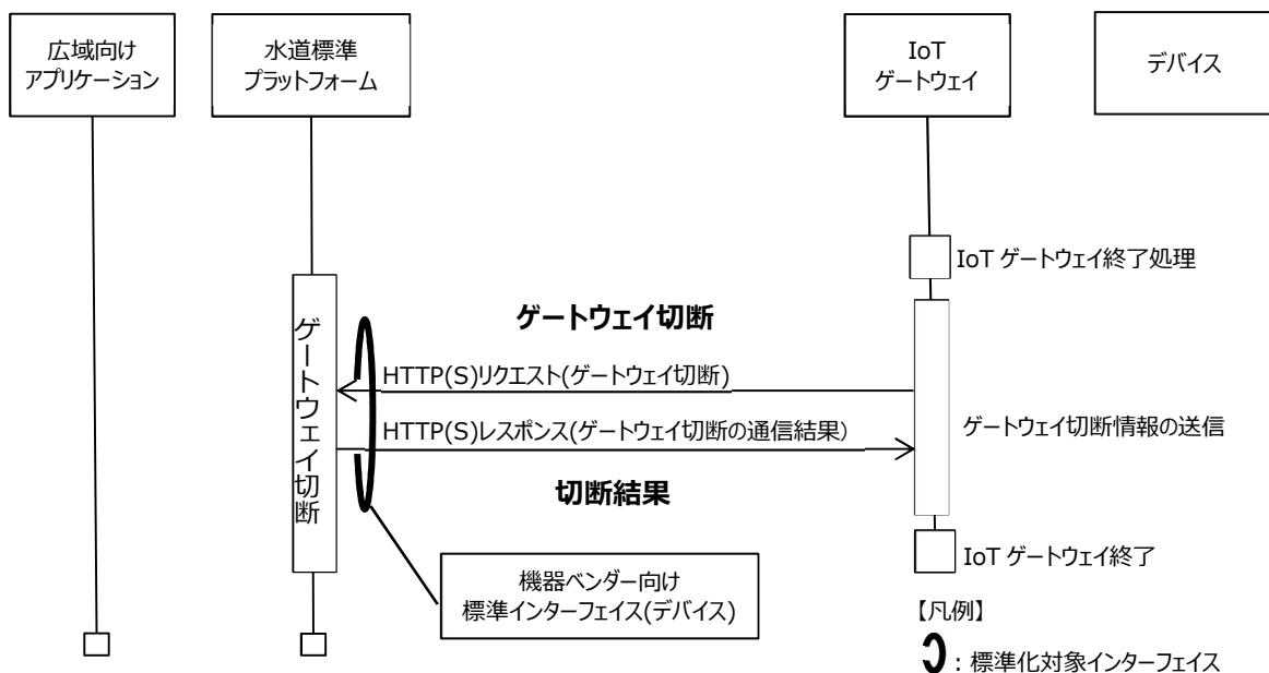
図 4-2: ゲートウェイ切断の詳細フロー
