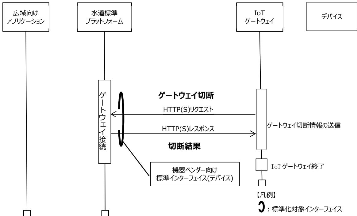
図 3-10: 詳細フロー(ゲートウェイ切断)
