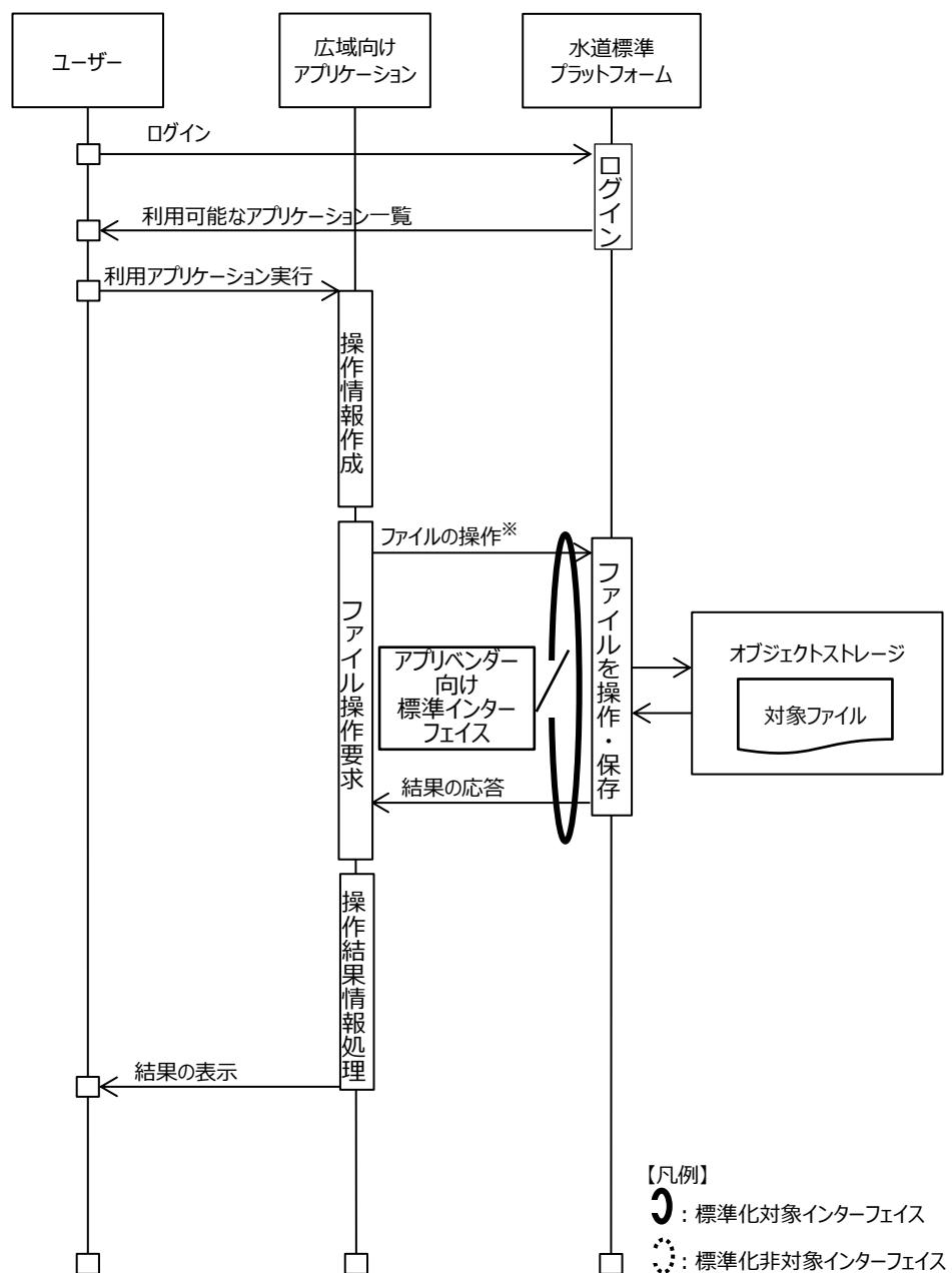
図 4-2: ファイル操作(追加/変更/削除)プル型
