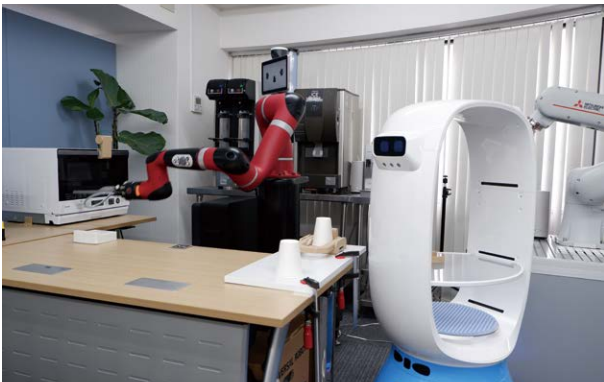
協働型ロボットの例。左のロボットがコーヒーの抽出、電子レンジの操作を行い、白いロボットが客席まで商品を運搬する。
